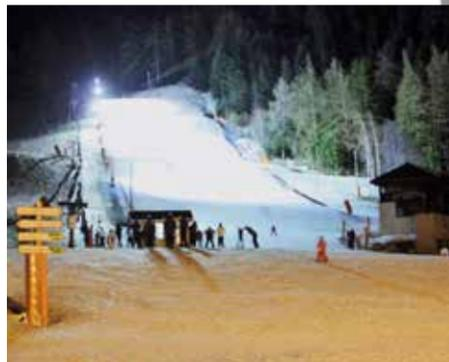
en recourant à l'hélictreuillage. Les anciens projecteurs ont été déposés et remplacés par 34 projecteurs plats à LED, plus performants et plus économes en énergie. Un mât, abîmé, sur les huit installés le long de la ligne de télésiège a également été remplacé et un nouveau mât a été ajouté au départ, au chalet du télésiège. Travaux terminés par le réglage des projecteurs. Coût de cette rénovation : près de 90 000 € HT.
