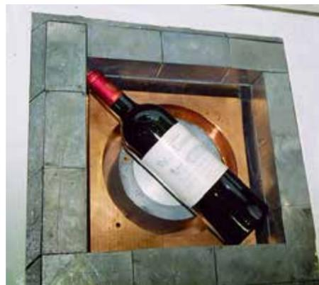
Utilisation insolite d'un détecteur germanium : la mesure de très faibles niveaux de radioactivité pour authentifier un millésime, dans le cas d'une suspicion de fraude. Ph. CENBG
