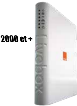
2000 et + L'ADSL apparu en 1999 donne accès au Haut Débit. Il deviendra multiservice dans les années 2000 : Internet, télévision, téléphone... Ci-contre la Livebox 1.2 de chez Orange (2008). L'ADSL a un débit de 8 Mbit/s (ADSL1 ou ADSL2) à 20 Mbit/s (ADSL2+) dans le sens descendant sur une ligne longue de 170 m. A 5,7 km de distance, les valeurs chutent à 2 et 3 Mbit/s. Le débit est tributaire de la distance.
