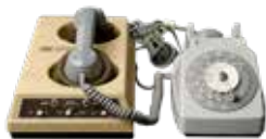
Années 80 Modem acoustique (1981). Vitesse de transmission : 240 bits/seconde. A cette vitesse, il faut 24 h pour télécharger une seule chanson au format MP3 actuel.
