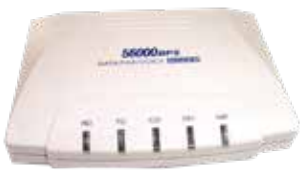
90... Le modem pour l'Internet à partir de 1994, à 56 kbits/seconde !
