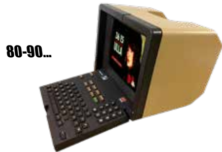
80-90... Le Minitel (1980-1990, extinction en 2012), embarquait un modem 4,8 kbits/s à 9,6 kbit/s connecté sur la ligne téléphonique. Il a préparé le premier boom Internet.
