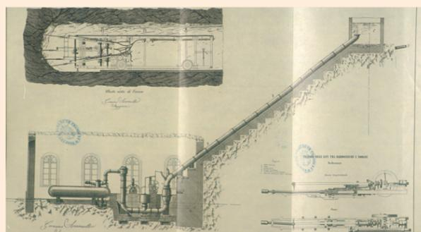
Le système de compresseur installés à Fourneaux (en lieu et place de l'Intermarché) qui permit à Sommeiller de percer beaucoup plus rapidement le tunnel du Mont-Cenis et de rendre inutile le chemin de fer Fell.
