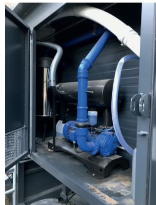
Désassemblée du 3 e point du tracteur, la machine dessinée par Grégory Personnaz est entièrement autonome, avec groupe électrogène, réserve d'eau, groupe froid, PRT, eau chaude...
