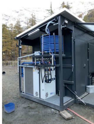
Désassemblée du 3 e point du tracteur, la machine dessinée par Grégory Personnaz est entièrement autonome, avec groupe électrogène, réserve d'eau, groupe froid, PRT, eau chaude...
