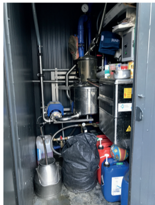
Désassemblée du 3 e point du tracteur, la machine dessinée par Grégory Personnaz est entièrement autonome, avec groupe électrogène, réserve d'eau, groupe froid, PRT, eau chaude...
