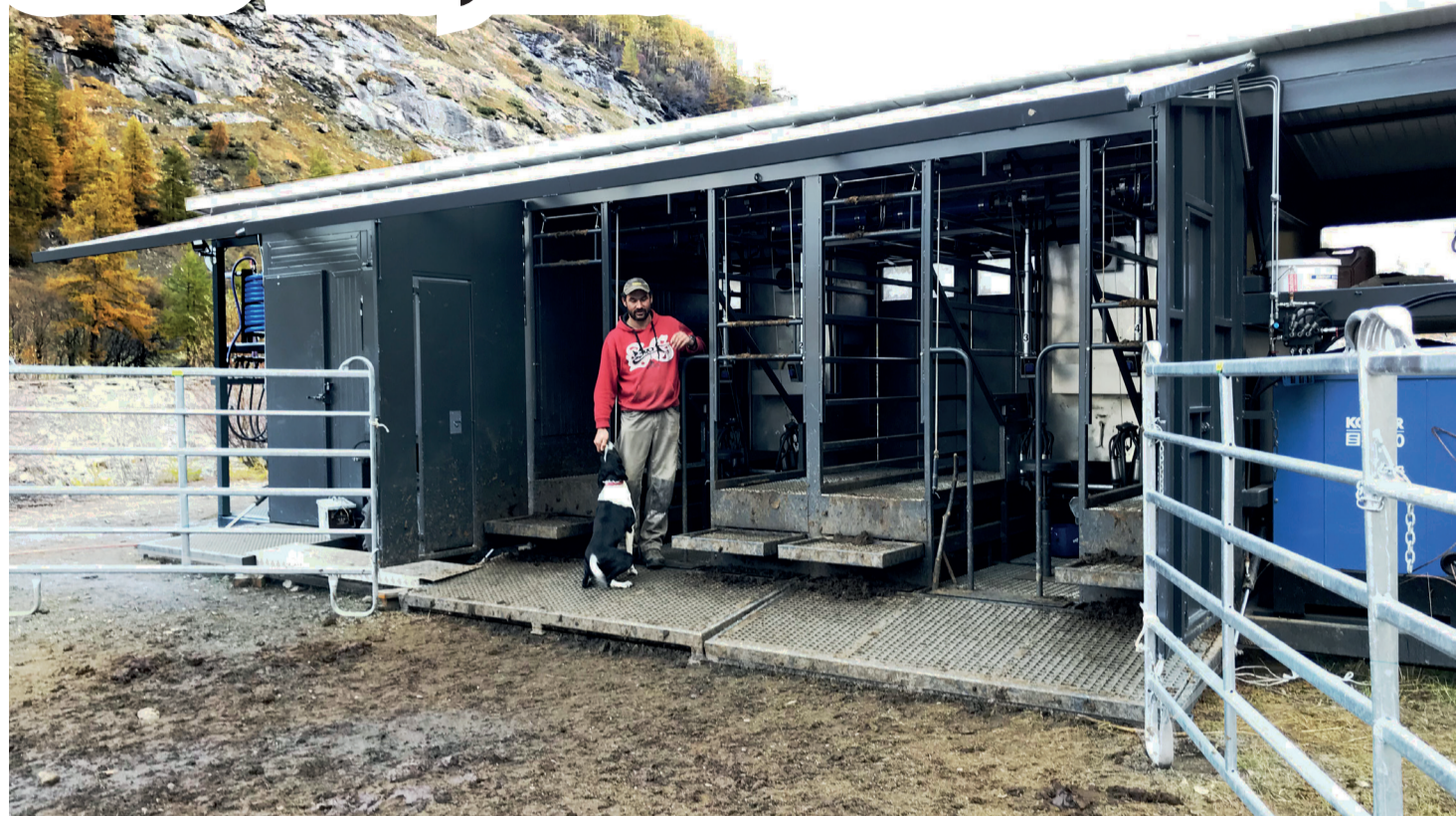
11,50 m de long, 8 t, la salle de traite mobile est entièrement automatisée, avec roues directionnelles et essieux relevables pour franchir les obstacles.
