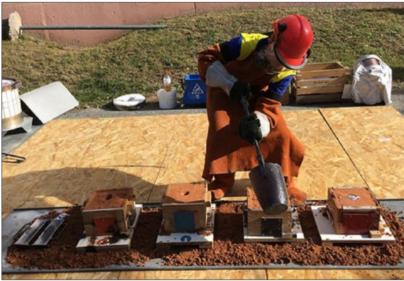
Parmi les animations, l'atelier fonderie d'aluminium a eu un grand succès. De la fabrication d'un moule par les participants, au coulage par un fondeur professionnel et au démoulage, toutes les étapes ont été effectuées sur place.
