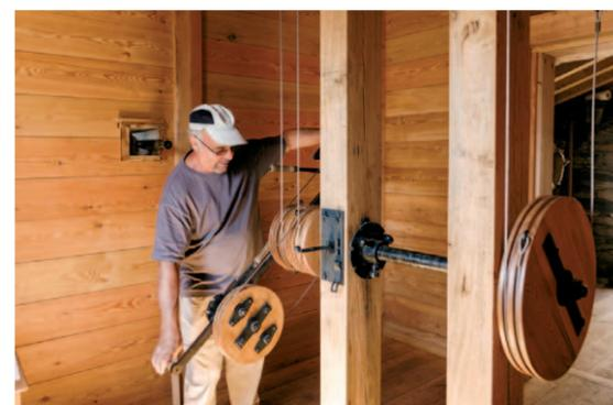
A l'intérieur du télégraphe, un système de poulies permet de manipuler les indicateurs et le régulateur pour former des signaux visibles depuis le poste suivant grâce à une longue-vue.
