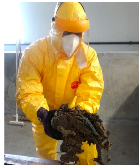
Batterie de pompes nécessaire au fonctionnement de la STEP. A droite, un agent entièrement protégé par des vêtements spéciaux montre un des nombreux paquets de lingettes agglomérées arrivant à la STEP par le réseau d'assainissement. Le respect des gestes barrières entraîne une utilisation massive de lingettes jetables pour de nombreux usages. Il est impératif de les jeter dans la poubelle et surtout pas dans les toilettes, elles encombreront le réseau, sont source de pollution et génèrent des manipulations inutiles.
