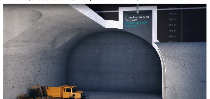
Les 4 puits, déboucheront dans une chambre creusée spécialement et reliée à la descenderie.
