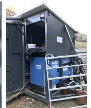
Désassemblée du 3 e point du tracteur, la machine dessinée par Grégory Personnaz est entièrement autonome, avec groupe électrogène, réserve d'eau, groupe froid, PRT, eau chaude...
