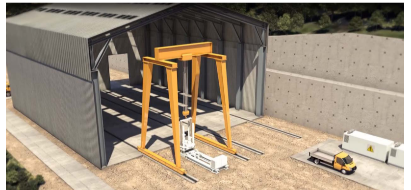
Le pont roulant servant à amener la machine de forage à la perpendiculaire des puits
